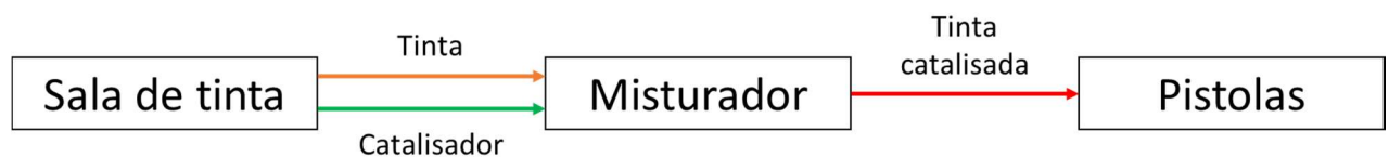
Figura 9 – Esquema simplificado da área de pintura agrícola.
