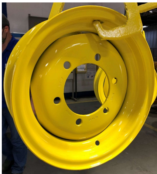
Figura 19: Foto de uma das rodas do primeiro teste que não apresentou defeitos de pintura.
