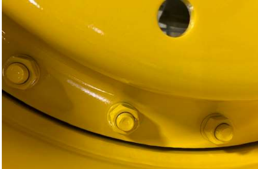
Figura 22: resultado do teste em larga escala na região do parafuso que apresentava bastante escorrimento.
